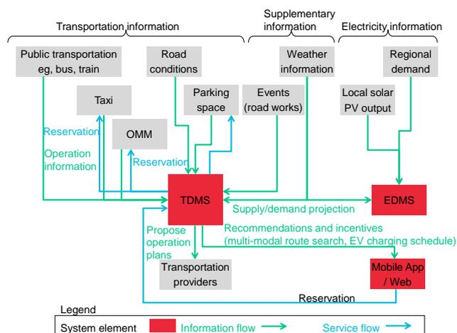
**Figure 1: Toyota’s integrated TDMS-EDMS platform**
